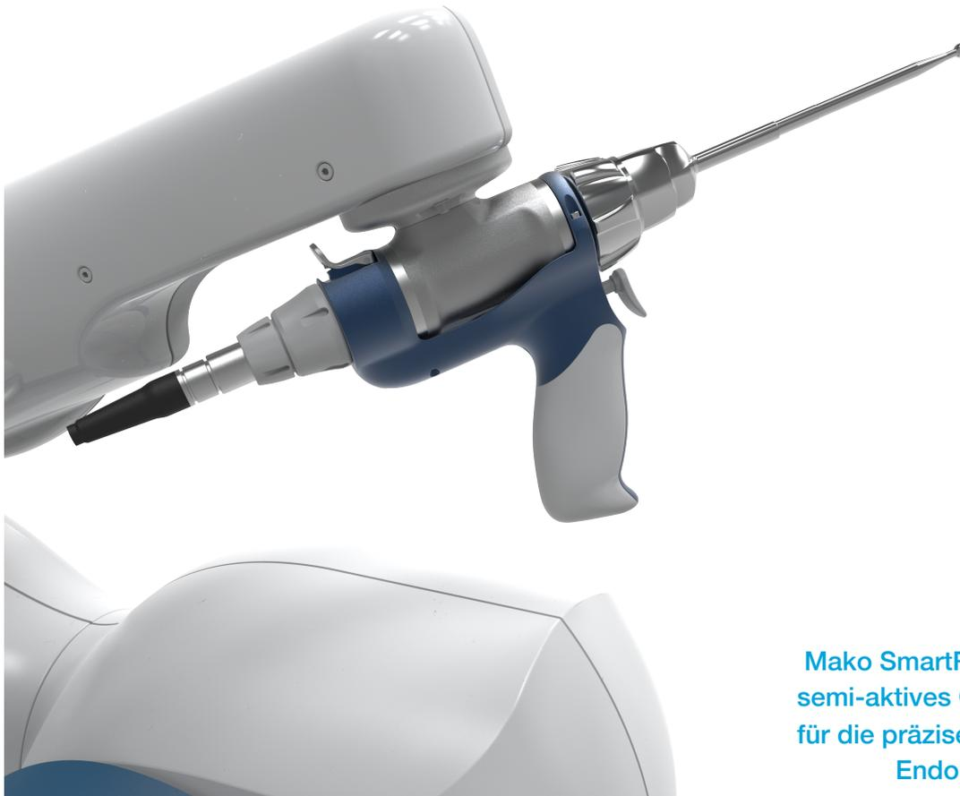
**Mako SmartRobotics™ ist ein semi-aktives Operationsroboter für die präzise Implantation von Endoprothesen**
